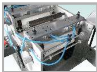
胶纸与胶片贴合，可做精密压力调整及间隙厚薄调整
