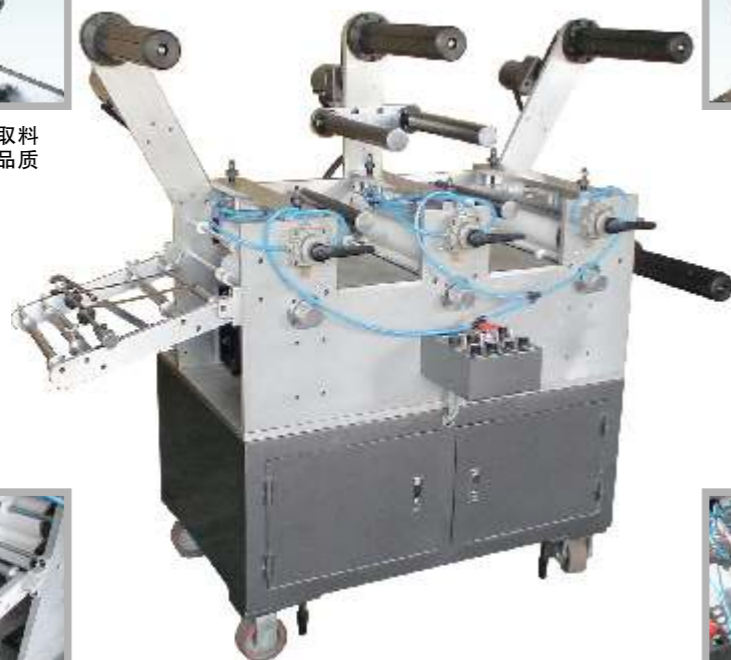
全自动运作，废料取走，取走角度及位置调整
